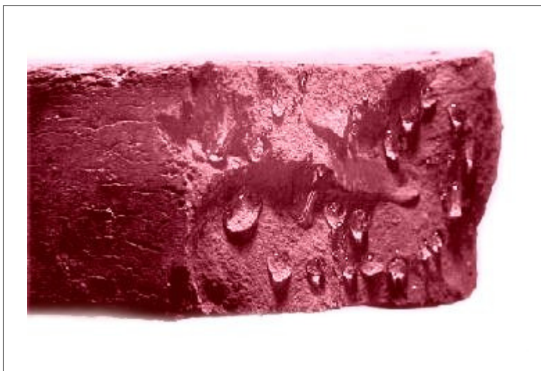
Imprägnierte Baustoffe sind mit Wasser nicht benetzbar.
