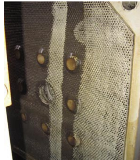
Filterpressen in Klärwerken werden per Hochdruck gründlich und schnell gereinigt. (hier: Dynajet® 500 me )
