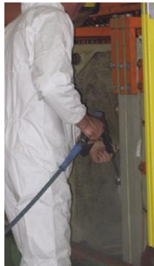
Filterpressen in Klärwerken werden per Hochdruck gründlich und schnell gereinigt. (hier: Dynajet® 500 me )
